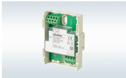
Módulo de saída (230V) FCA1209-Z1 – 1 saída com contatos de relé livre de potência – Controle de ventilação de incêndio, ar condicionado, elevadores, portas, instalações de controle, etc. – Corrente de funcionamento (quiescente): máx. 0,1 mA – Saída de relé (ohm):230 VAC, máx. 5 A/30 VDC, máx. 5 A Nº do pedido: S54400-B124-A1
