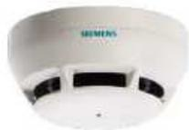
O detector de fumaça de amplo espectro FDO181 é um detector de fumaça óptico com um sensor óptico. Ele funciona de acordo com o princípio de dispersão para frente. O detector reage de forma extremamente sensível aos aerossóis de luz causados pelo fogo. A sensibilidade aumentada torna possível a detecção antecipada de princípio de incêndios e chamas abertas.
