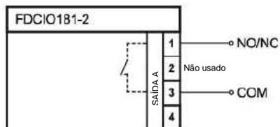
Diagrama de conexão para saída de contrato livre de potencial
