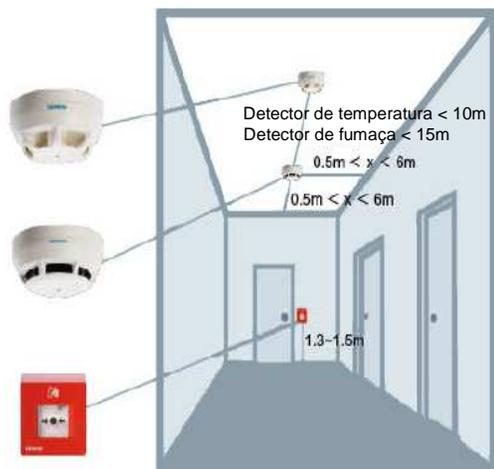
Nesta seção, ilustramos as melhores práticas para a instalação de equipamentos de detecção de incêndio. Embora nem todos os casos possíveis possam ser cobertos, elas se destinam a fornecer orientações. Regulamentos locais podem ser mais detalhados e devem ser sempre respeitados. Entre em contato com sua organização de vendas local Siemens para obter informações e documentação mais detalhadas.
